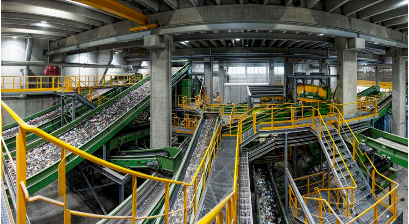
Auf über 800 Meter Förderbänder wird der Rest- und Sperrmüll sortiert
